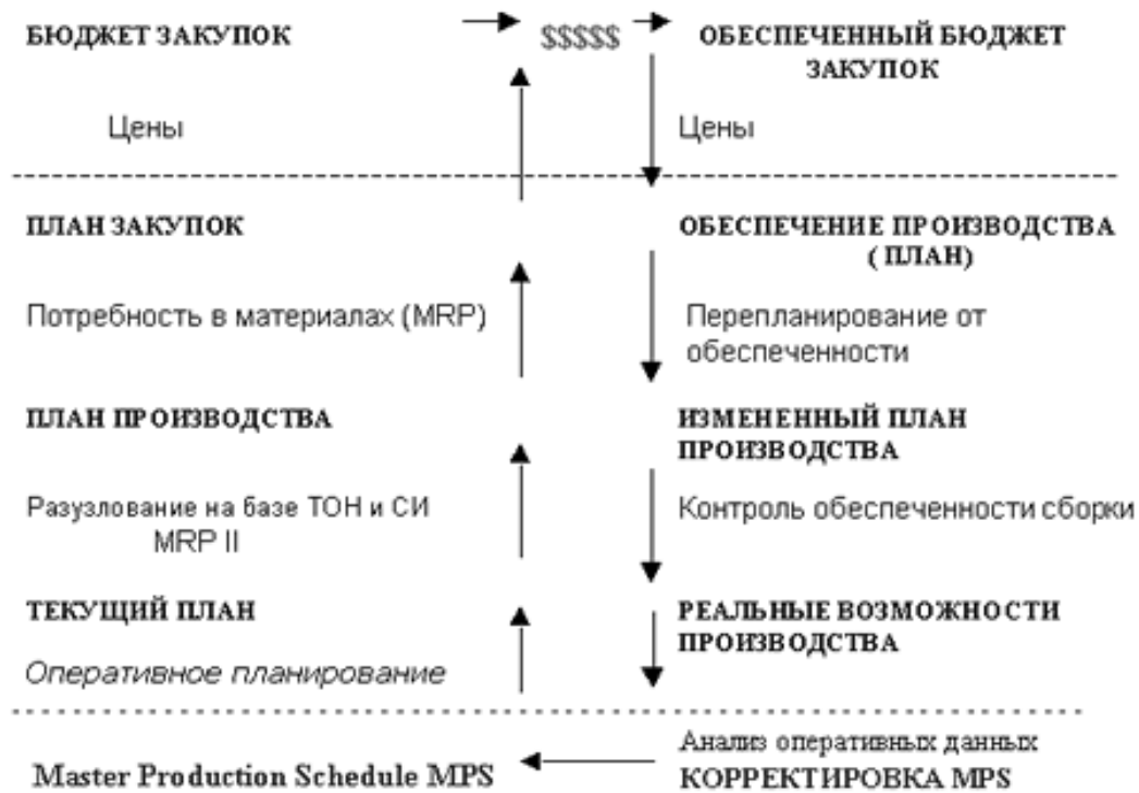
Рис. 5. «Петля» MPS / MRP планирования
