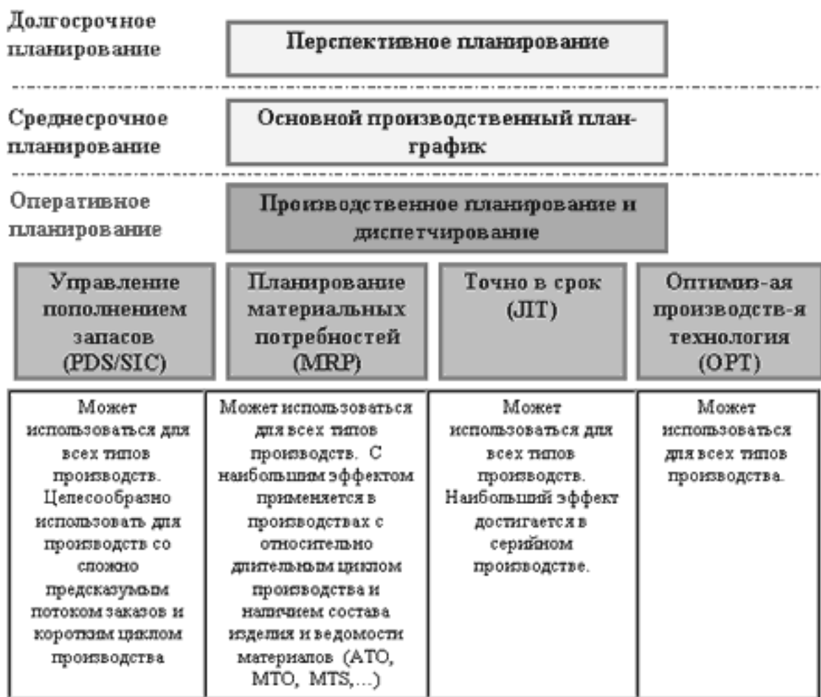
Рис. 2. Уровни производственного планирования и управления
