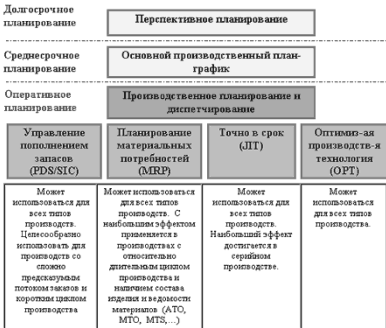
Рис. 2. Уровни производственного планирования и управления
